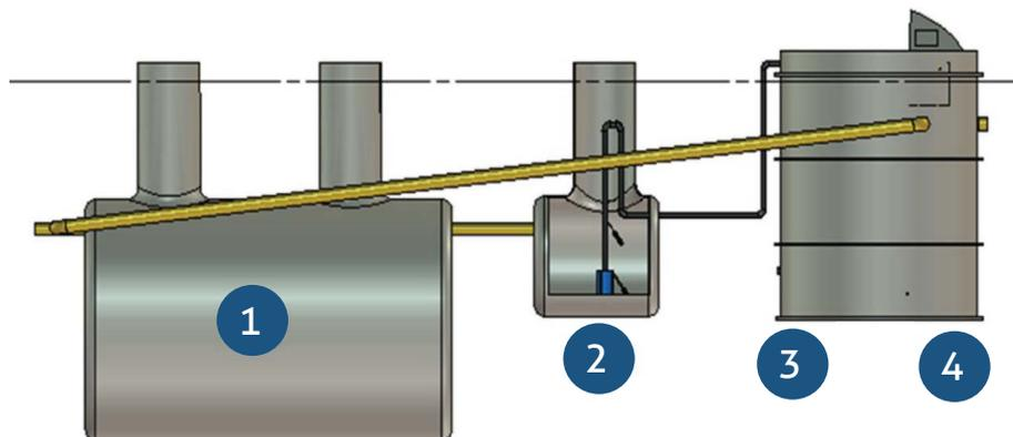
1. Les eaux usées entrent dans le système Tricel Maxus par le **bassin de décantation**. C'est là que se produit le traitement primaire. Les solides lourds sont séparés des eaux usées pour former une boue qui se dépose à la base du réservoir. Les solides plus légers, tels que les huiles, les graisses ou les lipides flottent à la surface des eaux usées et sont retenus dans le bassin de décantation.
